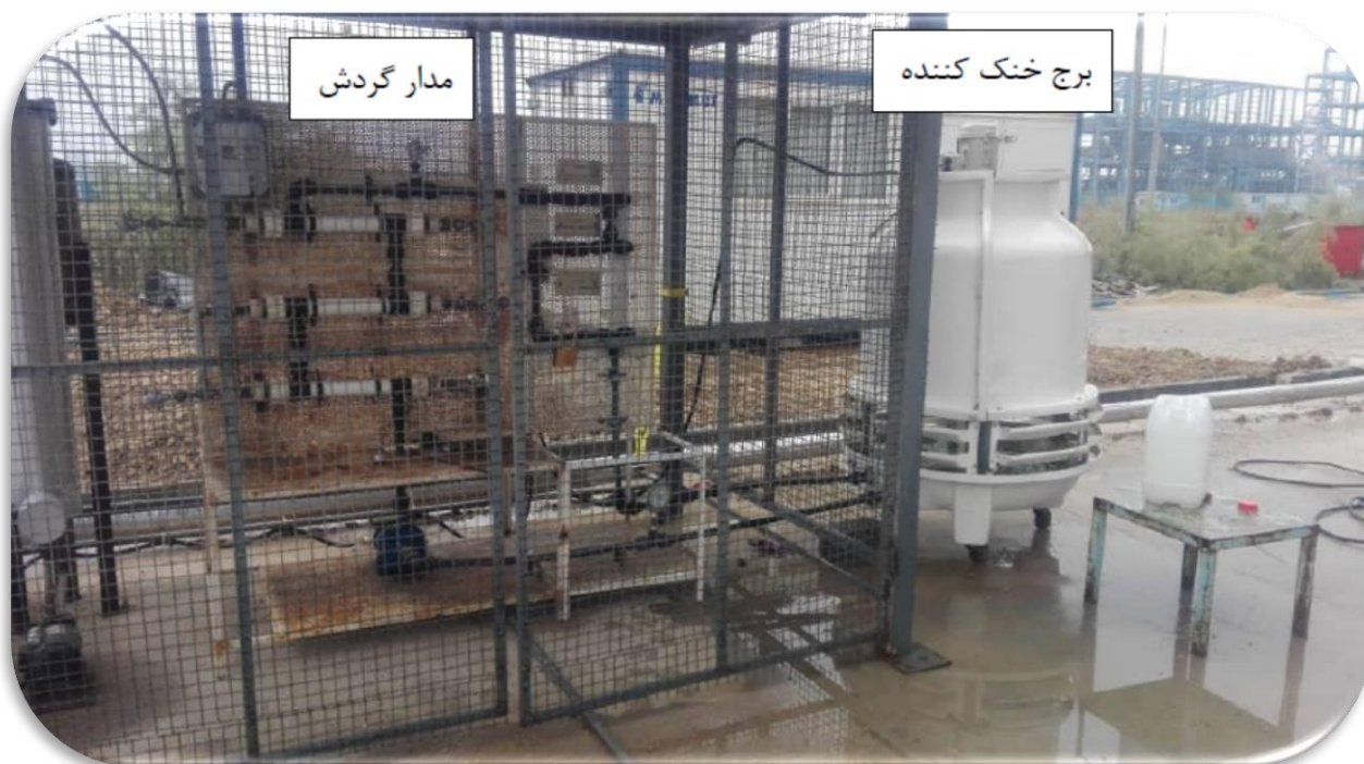
شکل (۲): شمای کلی پایلوت مورد استفاده در بررسی رسوب برداری
